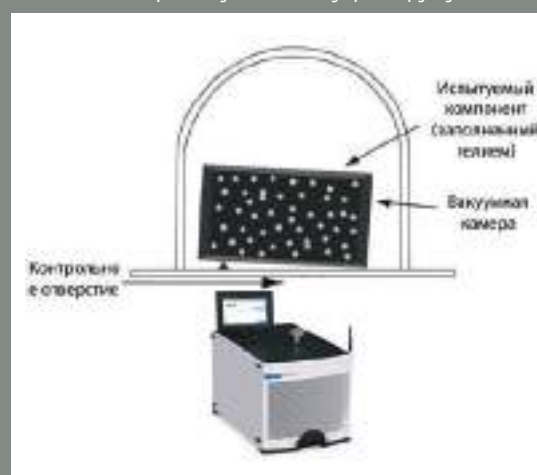
Измерение утечки: изнутри-наружу
